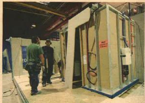
RUMSLIGT: Ytterväggsreglarna läggs på plats för svejtning. Så småningom ska personalen klara ett högre flöde i fabriken med befintlig bemanning genom automatisering.
