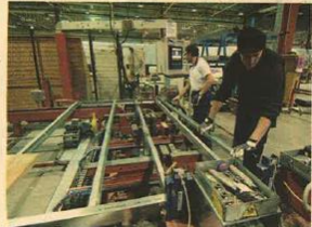
RAMVERK: Vid första stationen sveats alla regelverk samman. Ytterväggsregel i lättstål från Lindab med sveatsad profil för att bryta köldbryggan.
